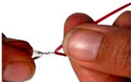
شیوه اتصال سیم دو جاباطری به هم
